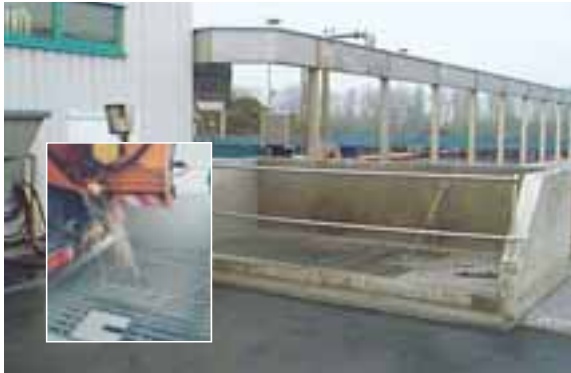
Tolva de alimentación con reja y tornillo transportador
