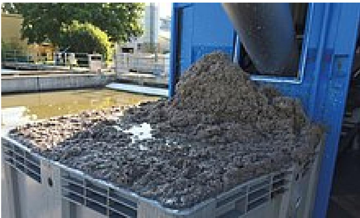
*Material de tamizado fino deshidratado previamente mediante la prensa de lavado WAP® liquid de HUBER para su posterior digestión*
